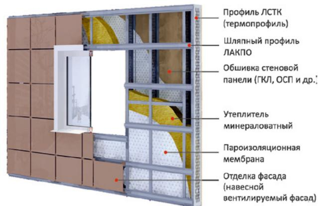
Рис. 1 Состав стеновой панели.
