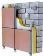
Система навесного вентиляруемого фасада с кляммерным креплением для металлокассет
