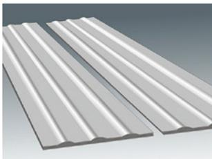
Осадительные пластины (электроды) – профильные элементы различного сечения толщиной 1,2 - 2 мм длиной до 12 м, выполненные из холоднокатаной стали, предназначенные для улавливания различных загрязнений воздуха
