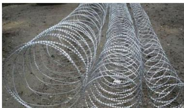
СББ «Гюрза» - это спираль, навитая из АКЛ. Витки спирали скрепляются скобами в трёх (или более) равноудаленных точках по окружности, образуя жесткую пространственную конструкцию, обладающую повышенными защитными свойствами. Производится в соответствии с ТУ 1275-002-10858149-2014
