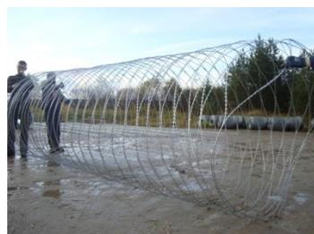
СББ «Супер-Гюрза» - это усиленная спираль большого диаметра - 1700 мм. Изготавливается из пружинной проволоки диаметром 4 мм. Высота барьера безопасности «Супер-Гюрза» в развернутом состоянии составляет не менее 1500 мм. Применяется для внешних запретных зон особо важных объектов (заводы, аэропорты), как временное быстровозводимое ограждение строительных объектов; ограждения на болотистых грунтах, где невозможно или экономически нецелесообразно устанавливать ограждения на фундаментах.
