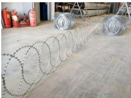
ПББ «Гюрза» - это полотно, изготовленное в одной плоскости из АКЛ. Витки полотна скрепляются друг с другом скобами со смещением каждого следующего витка на определенный шаг. Применяется для создания инженерных защитных ограждений периметра различной конфигурации и установки на основное ограждение. Полотна ПББ серийно производятся высотой 500, 600, 900 и 950 мм.
