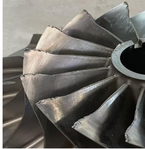
ПОВРЕЖДЕНИЯ, ВЫЗВАННЫЕ ПОПАДАНИЕМ ПОСТОРОННЕГО ПРЕДМЕТА
