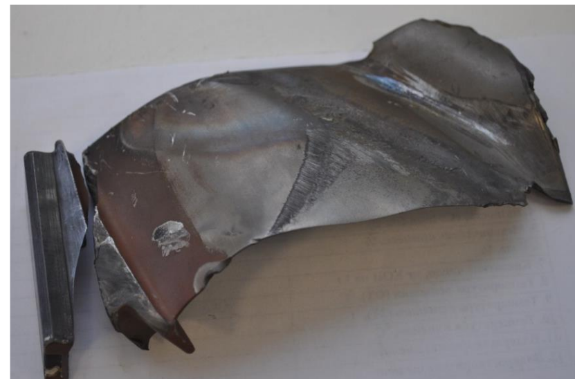
ЛОПАТКА ПОСЛЕ РАЗРУШЕНИЯ
