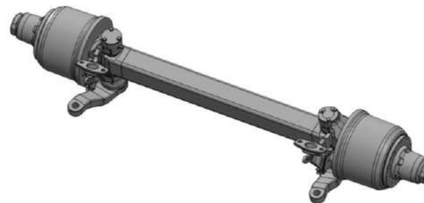
Рисунок 4.13 - С принудительным управлением (принудительно-поворотный) осевой агрегат
