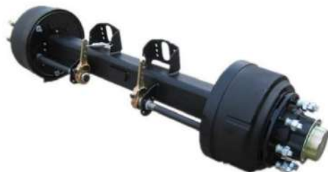
Рисунок 4.9 - Осевой агрегат с барабанным тормозным механизмом
