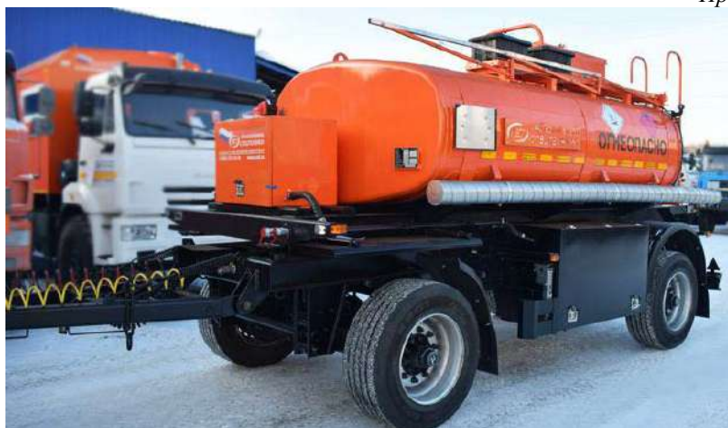
Вариант 1 - Цистерна рамной конструкции
