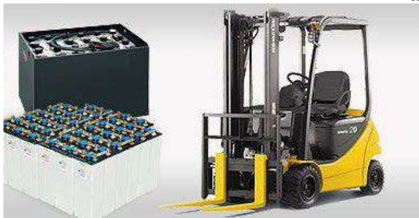
Тяговый накопитель энергии
