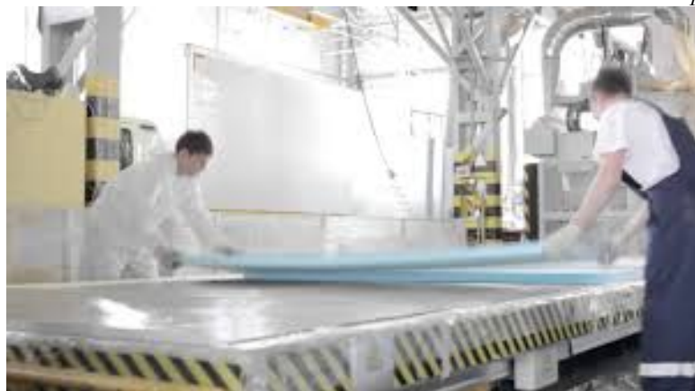
Склейка изотермической панели
