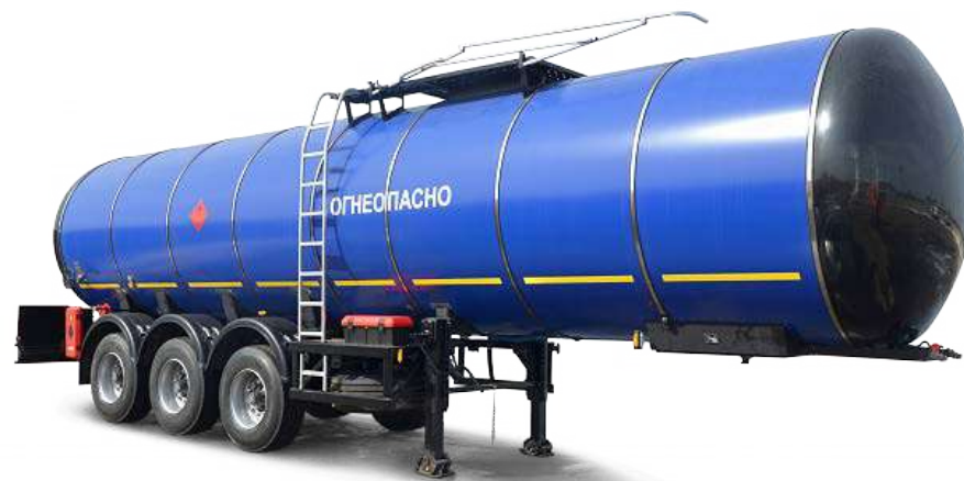
Вариант 2 - Цистерна безрамной (несущей) конструкции
