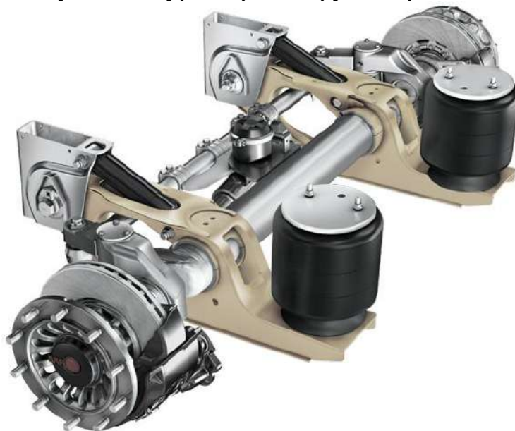
Рисунок 4.1 - Осевой агрегат с пневматической подвеской
