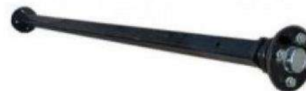
Рисунок 4.11 - Осевой агрегат без тормозных механизмов
