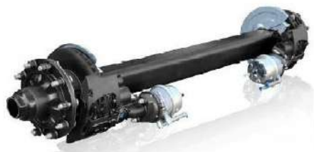
Рисунок 4.10 - Осевой агрегат с дисковым тормозным механизмом
